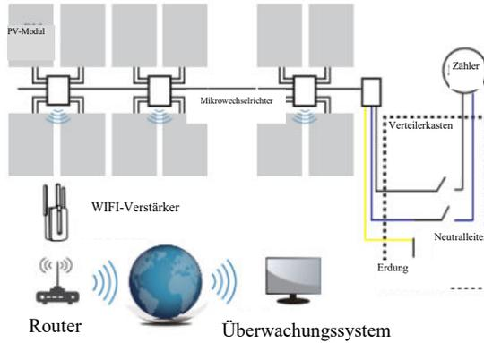
**HINWEIS:** Wenn das WLAN-Signal in dem Bereich des Mikrowechselrichters schwach ist, muss ein WLAN-Signalverstärker an einer geeigneten Stelle zwischen dem Router und dem Mikrowechselrichter angebracht werden.
